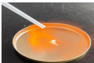
図1 白金箔上での水素の燃焼反応
